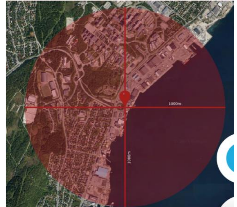
Bilde 1 – Evakueringssone pga. fare for BLEVE
